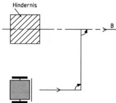
In den Zeilen 90 bis 110 benutzen wir das Kommando £TX um die Position zu ermitteln und auf jeden Fall auf die Ausgangsposition  $X=0$  zurückzufinden. Anschließend wird wieder auf den Originalkurs eingeschwenkt und geradeaus weitergefahren.
