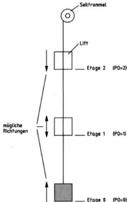
Bild 4.4: Arbeitsweise eines Aufzugs.
