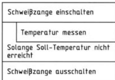
Bild 8.5: Struktogramm zum Programm "Schweißen mit Sensor".
