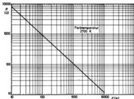
Bild 6.3: Kennlinie des fischertechnik Fotowiderstandes aus einem Datenbuch.
