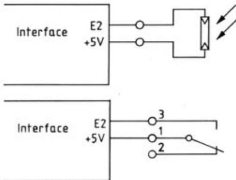
Bild 5.1: Ein Fotowiderstand ersetzt den Taster aus Bild 4.3.
