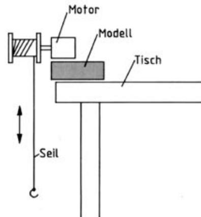
Bild 4.1: Eine Seilwinde kann man zum Experimentieren auch an einer Tischkante anbringen.
