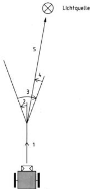
Bild 10.17: Richtungskorrektur bei der Anfahrt auf die Lichtquelle.
